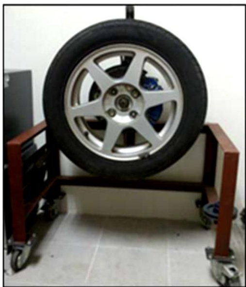
شکل ۲- آزمون سنجش کاهش فشار باد تایر در شرایط ایستا و بدون بار [۱۱]
