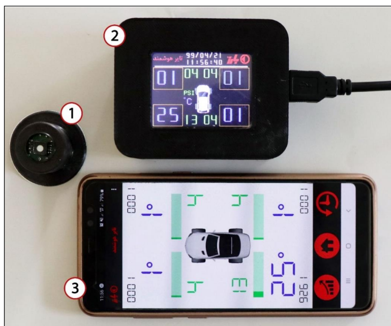
شکل ۲- اجزای اصلی تایر هوشمند بارز: (۱) مجموعه سنسور، (۲) واحد کنترل، (۳) برنامه کاربردی تلفن همراه (توجه شود که در شکل بالا تنها یک سنسور به واحد کنترل متصل شده است).
