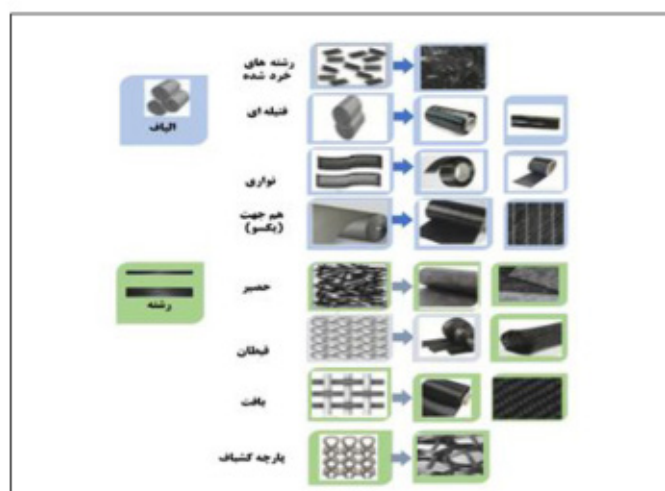
شکل ۴. انواع فرآیندهای بافت و شکل دهی الیاف جهت استفاده در کامپوزیت‌های زمینه پلیمری [۱]
