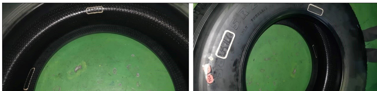
شکل ۵: تگ RFID قابل اتصال روی دیواره تایر B بعد از پخت آن
