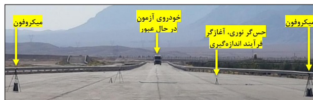
شکل ۴- میدان آزمون و امکانات و تجهیزات اندازه‌گیری نوفه‌ی تایر/جاده و نوفه‌ی خودرو، در میدان آزمون گروه صنعتی بارز
