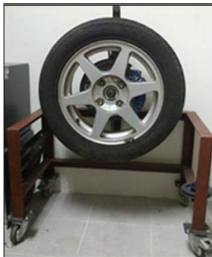
شکل ۲- آزمون سنجش کاهش فشار باد تایر تحت شرایط ایستا و بدون بار
